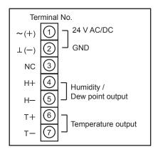
Figure 27. Wiring diagram
