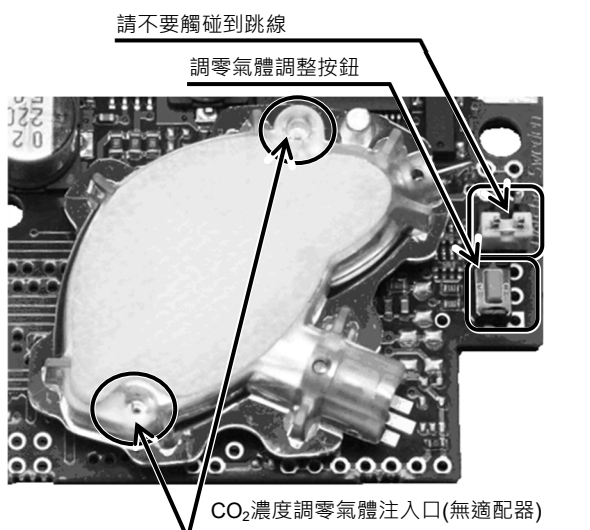
圖12 按鈕、氣體注入口配置
